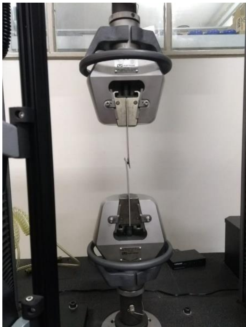
Figura 15: Momento de rompimento no ensaio de cisalhamento.
